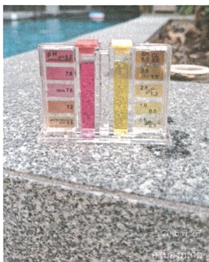
รูปภาพที่ 2.41 การตรวจเช็ค pH, Cl
